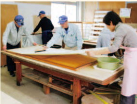
障子の張り替え作業
