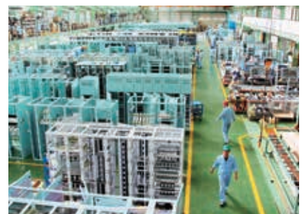
工場内に並べられた「船舶自動制御システム」。完成後、国内外の造船所で船舶に組み込まれます。
