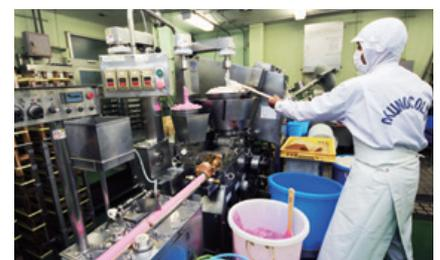
かまぼこの身は、機械で板の上に成形し、蒸した後、冷やされ、包装して出荷されます。
