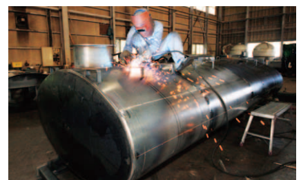
一村製作所の主力製品・車載用タンクの作製。平成16年に全国一の年間出荷台数を達成しました。
