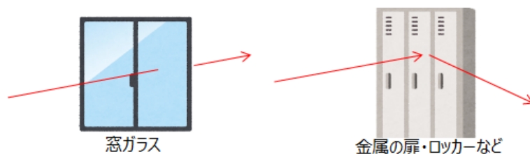
参-図2 電波の特徴 反射や透過など
