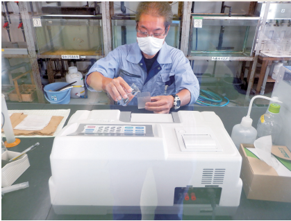
濁度・色度を計測している様子
