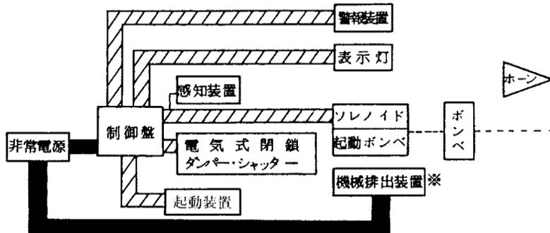
※ 不活性ガス消火設備、ハロゲン消火設備に限る。
