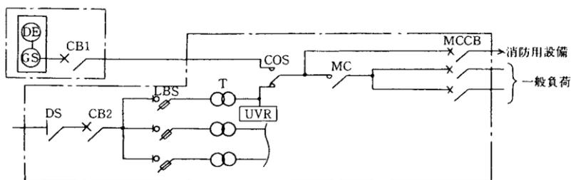
注 UVRは、変圧器の二次側から自動切替装置までの間に設けること。
