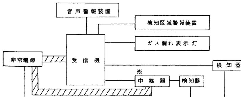
※ 検知器、受信機又は他の中継器から電力を供給されない方式の場合は、非常電源付の耐熱配線とすること。
