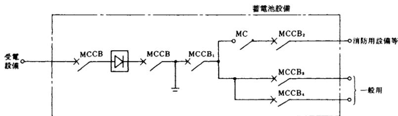
注 主遮断器MCCB1は過負荷及び短絡時にMCCB3, MCCB4より先に遮断しないものとする。
