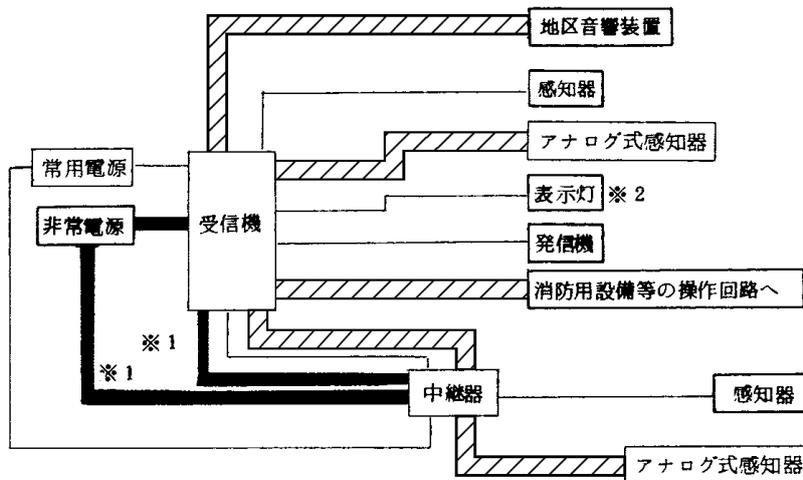
※1 中継器の非常電源回路(受信機又は中継器が予備電源を内蔵している場合は一般配線でよい。)
