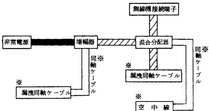
※ 漏洩同軸ケーブル、同軸ケーブル、空中線は難燃性を有し、かつ、耐熱性を有するように設置すること。
