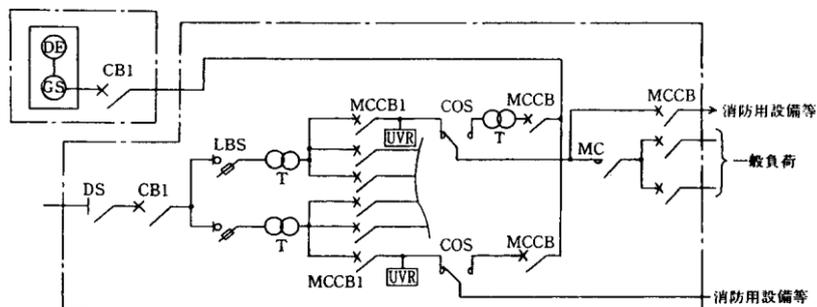
注 UVRは、MCCB1から自動切替装置までの間に設けること。
