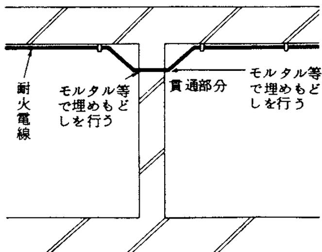
(3) 電線管等の設置場所が不燃区画、パイプシャフト等で規則第12条第4号ニ(ロ)に規定する配線が必ずしも必要でない判定される場所である場合。
