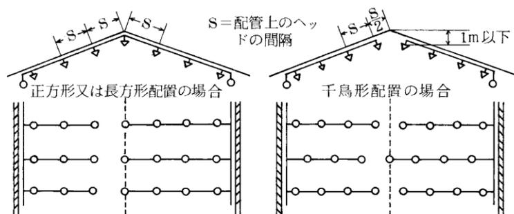
イ ヘッドを取付ける面の傾斜が1分の1（45°）を超えるもので当該屋根又は天井の頂部にヘッドを設ける場合は、次図の要領により当該屋根又は天井とヘッドとの水平離隔距離を60cm以上とすることにより、当該屋根又は天井の頂部からの垂直距離をアによることなく1mを超えて設けることができる。◆
