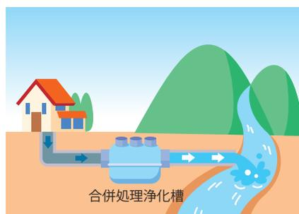
各家庭に合併処理浄化槽を設置して、生活排水を個別に処理する方式
