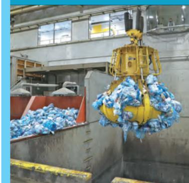
プラスチック製容器包装を貯留ピットに一時的に貯留し、クレーンで受入ホッパに運びます。
