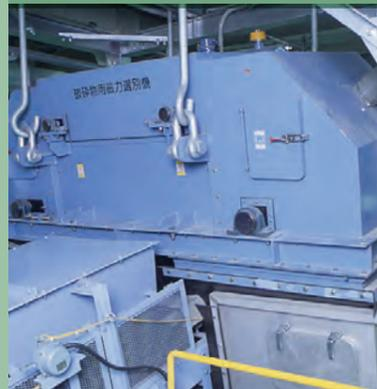
破碎したごみの中から、磁石の力で鉄を選別します。
