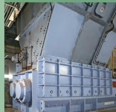
二軸の異なる回転数の破碎刃によって、燃やせないごみ・粗大ごみを粗く破碎します。
