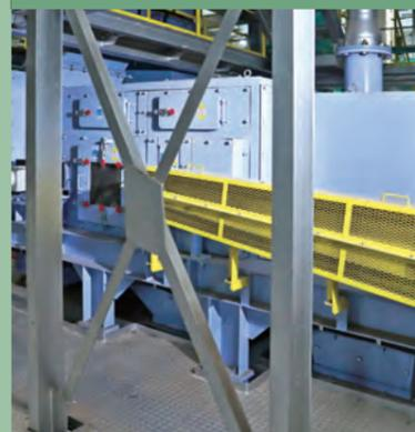
破碎したごみの中から、磁石の作用でアルミを選別します。
