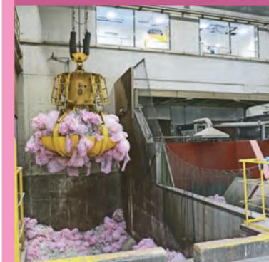
ペットボトルを貯留ピットに一時的に貯留し、クレーンで受入ホッパに運びます。
