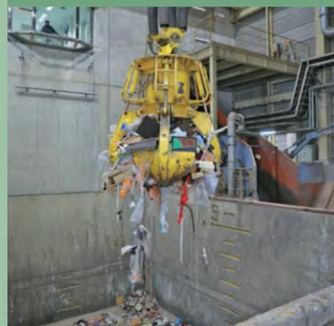
燃やせないごみ・粗大ごみを貯留ピットに一時的に貯留し、クレーンで受入ホッパに運びます。
