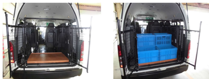
図 4.17 特設棚及びコンテナ積載状態
