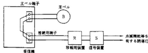
受信機に移報用端子が設けられているが、すでに他の設備に接続されている場合
