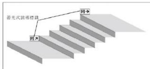
※ 避難する際の錯覚（踏み面がきわめて暗い環境のため、階段なのか踊り場なのかを判断できない）による転倒、転落等を防ぐため、蓄光式誘導標識の設置高さは、統一した設置箇所とすることが望ましい。
