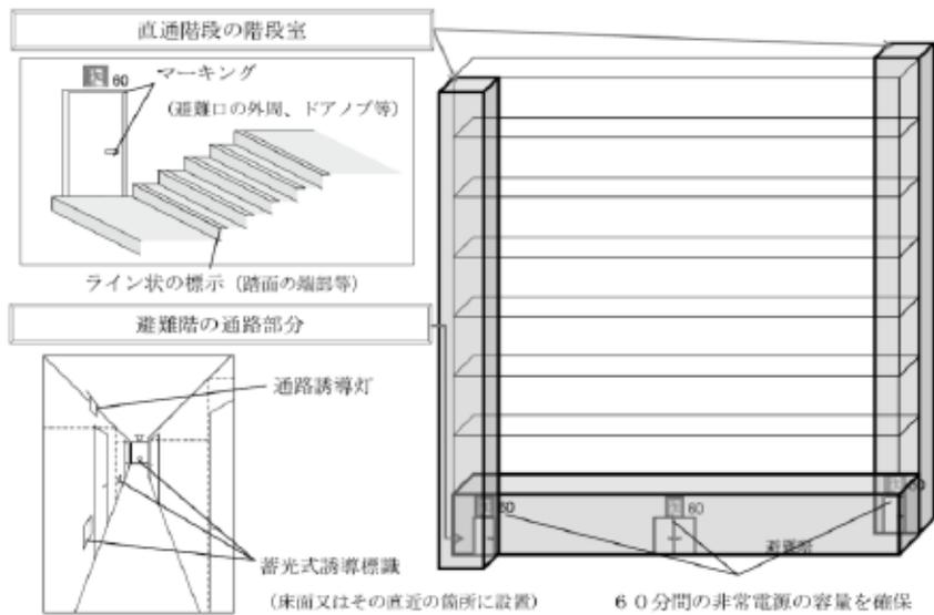
(参考) 通路誘導灯の非常電源の容量を60分間確保する場合 (=蓄光式誘導標識を設置しない場合) の設置イメージ
