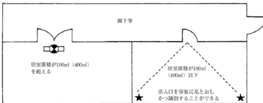
図16-11 居室から廊下への出入口の設置例
