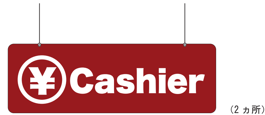
アルミ複合板フィルム貼仕上 (両面) ワイヤー天吊式
