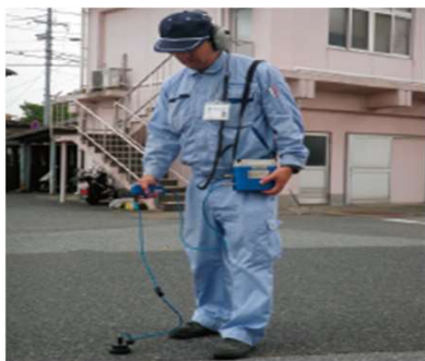
漏水探知機での調査
