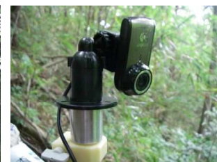
←高所観察機材：先端にカメラが付いている（H22）
