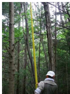
←高所観察機材：先端にカメラが付いている（H22）
